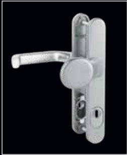
Schutzbeschlag Wechselgarnitur mit Langschild, außen Knopf abgekröpft und Kernziehschutz
