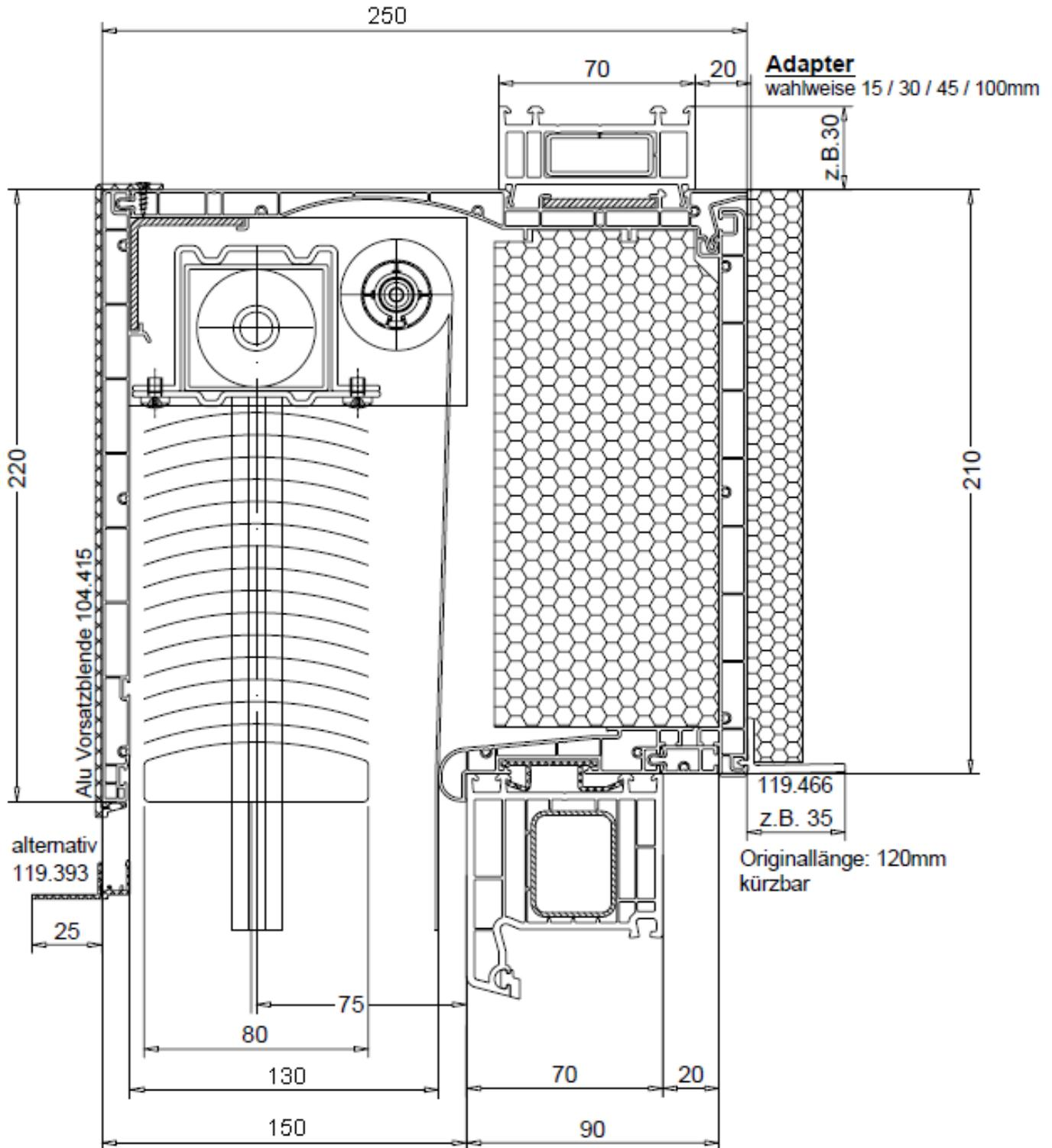
Abbildung zeigt einen T-Variant RS 210 mit optionalen Möglichkeiten der Kastenausbildung (Insektenschutzrollo in Planung)
